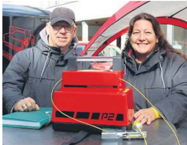
Problem Elektrizität: Mitarbeiter der Firma Zimmermann aus Niederzier präsentierten ein Spezialgerät, mit dem gefährliche Spannung im Wasser erkannt werden kann.
