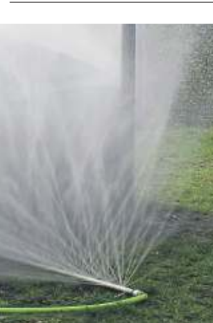
Dieses neue Löschsystem erinnert an einen Rasensprinkler: Der erzeugte Sprühnebel soll den Einsatzkräften insbesondere bei Defekten an E-Autos wichtige Zeit verschaffen.
