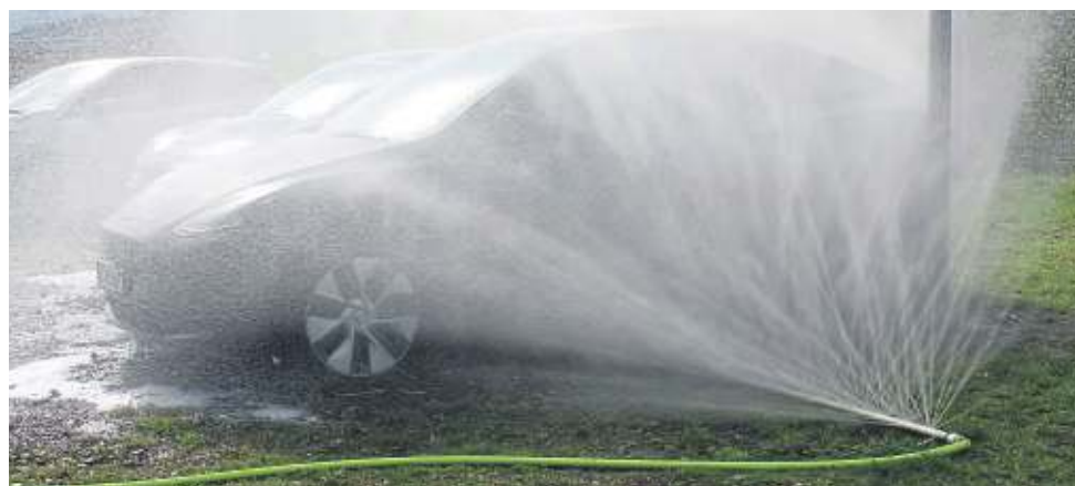
Dieses neue Löschsystem erinnert an einen Rasensprinkler: Der erzeugte Sprühnebel soll den Einsatzkräften insbesondere bei Defekten an E-Autos wichtige Zeit verschaffen.
